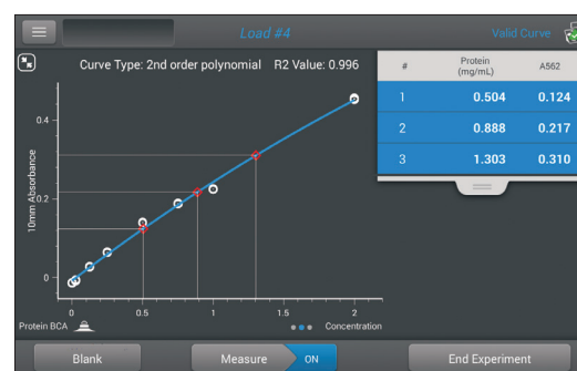
Результаты анализа BCA: концентрация общего белка (три красных квадрата) и стандартная кривая
