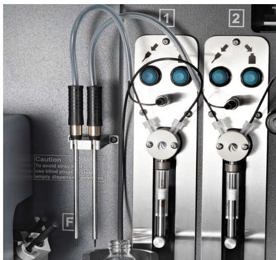
Рисунок 1. Диспенсеры позволяют выполнить простое и точное дозирование реагентов.
